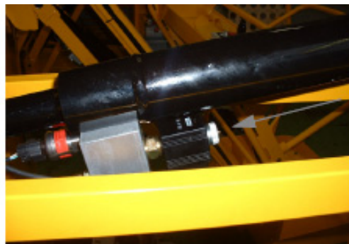
5. kép – a lengőkar kézi leeresztése
